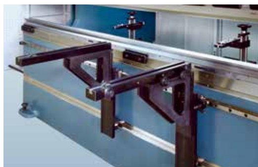
Supporti lamiera frontali scorrevoli su guide con pattini a ricircolo di sfere
