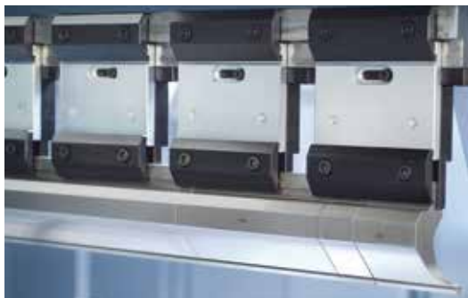
Sistema europeo di bloccaggio utensili superiori
