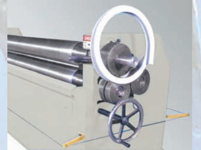
Alberi Prolungati Per Rulli Piegaprofili (Optional) Optional extended roll shafts for profile bending and bending rolls Extra Verlängerte Walzenenden für Profilbiegen und Profilbiegewalzen
