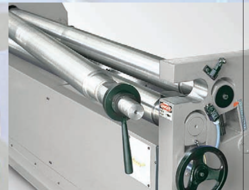
Rullo Superiore Apribile Per Estazione Virole (Standard) Standard Manual Drop End Standard Manuelles Klapplager
