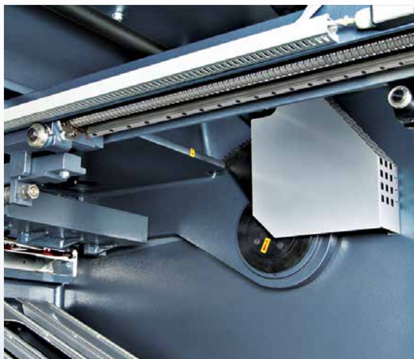
Viti a ricircolo di sfere del registro posteriore
