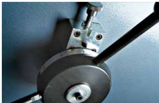
Regolazione dell'interspazio tra le lame
