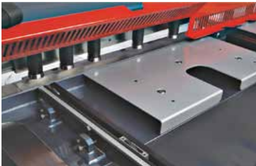
Protezione sollevabile nel primo metro Tavolo a sfere di scorrimento Premilamiera oleodinamici
