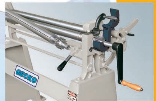
Rullo Superiore Apribile Per Estrazione Virole (Standard) Standard Manual Drop End Standard Manuelles Klapplager
