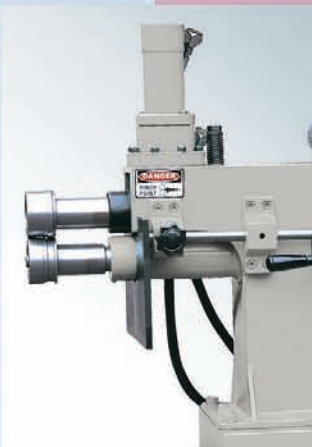
Movimento idraulico Rullo Sup. (Optional) Optional hydraulic top roll Hydraulische Oberwelle
