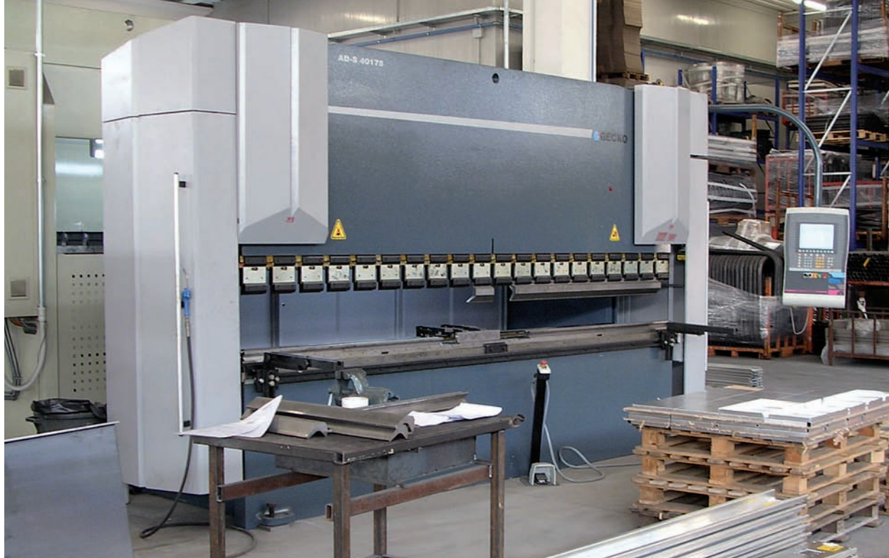
FIG|03 La seconda delle presse piegatrici Gecko installate alla GB Nord. Della serie AD-S, essa ha 175 t di forza e lunghezza di piega di 4 m. Nell'azienda di Fonte (TV) questa macchina, di minori dimensioni, è quella utilizzata per i pezzi meno ingombranti ma di grandi esigenze di qualità e precisione di piegatura. 1423
