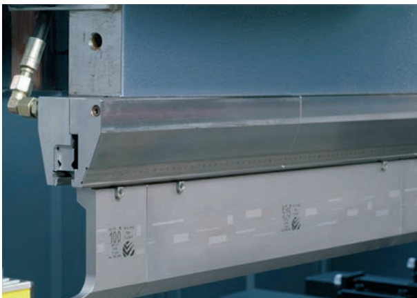
FIG 05 | Dettaglio di una pressa Gecko: il bloccaggio oleodinamico di punzoni e matrici.
