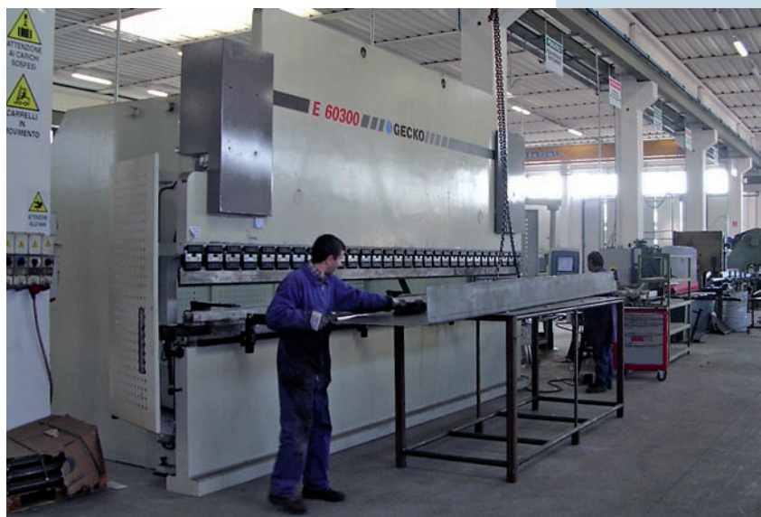
FIG|04 La pressopiegatrice Serie E impegnata nella piegatura di una grande lamiera.
